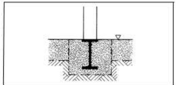
Graben für Stützrahmen (Grundträger + Stahlwandstützen)
